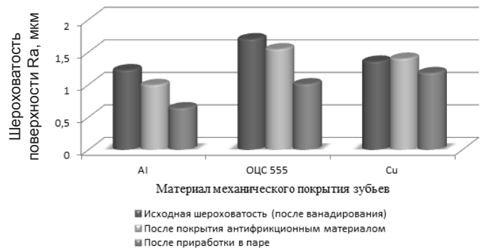
Рисунок 6 – Диаграмма изменения шероховатости поверхности сопряженного с шестерней зубчатого колеса с антифрикционным покрытием
